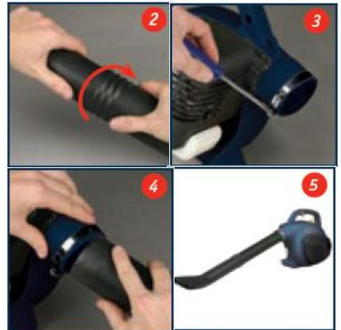
Pour retirer le tube et la buse, desserrez d'abord la vis de l'anneau de fixation. Faites tourner le tube pour le détacher de la sortie d'air du carter du souffleur.
